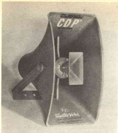
Altoparlante per impianti di amplificazione, dotato di due trombe, una per le frequenze alte e l'altra per le frequenze basse e medie. Se montato come illustrato nella foto, ha un largo angolo di dispersione orizzontale.
