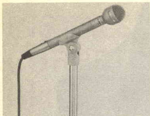
Ecco un tipico microfono dinamico a cardioide per applicazioni professionali e che ha una caratteristica nettamente direzionale.
